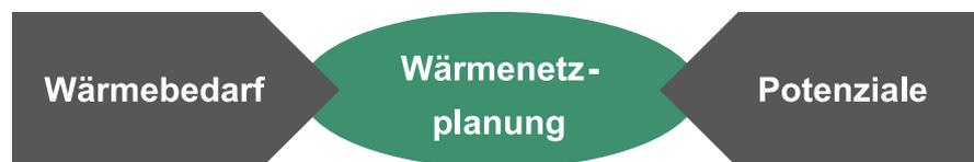
Im Rahmen der **Wärmebedarfsermittlung** werden zunächst Wärmenetze skizziert (d. h. planerisch grob entworfen), die sich auf Basis der Wärmeliniedichten besonders für eine Wärmeversorgung eignen. Dort, wo Wärmeliniedichten von über 2.000 kWh/m (vgl. KEAN, eigene Berechnungen) ermittelt wurden und relativ „zusammenhängend“ auftreten, sind Wärmenetze grundsätzlich technisch-wirtschaftlich denkbar.
